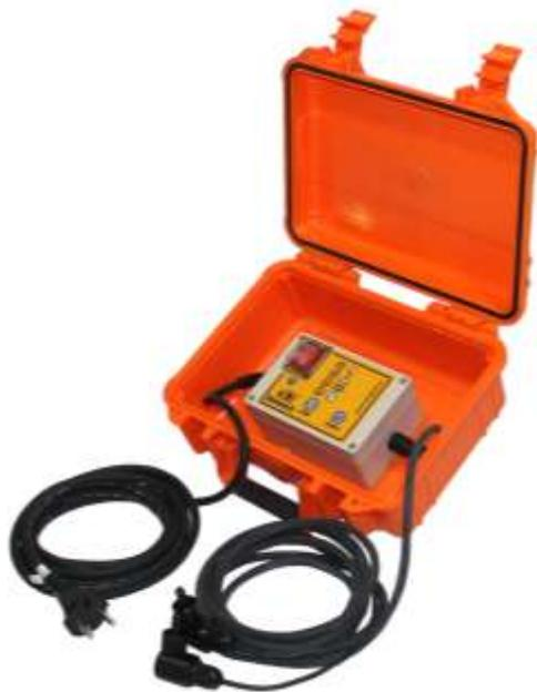
Электросварочный аппарат ZERN-160 - 230 В, 50 Гц, 1150 Вт, для сварки сточных труб и электрических соединителей ПЭ 40-160 мм. Электронное управление с акустическим и оптическим контролем процесса сварки. В стабильном, ударопрочном пластиковом корпусе. Сварщик постоянно установлен в пластиковом корпусе. Сменные наконечники.
